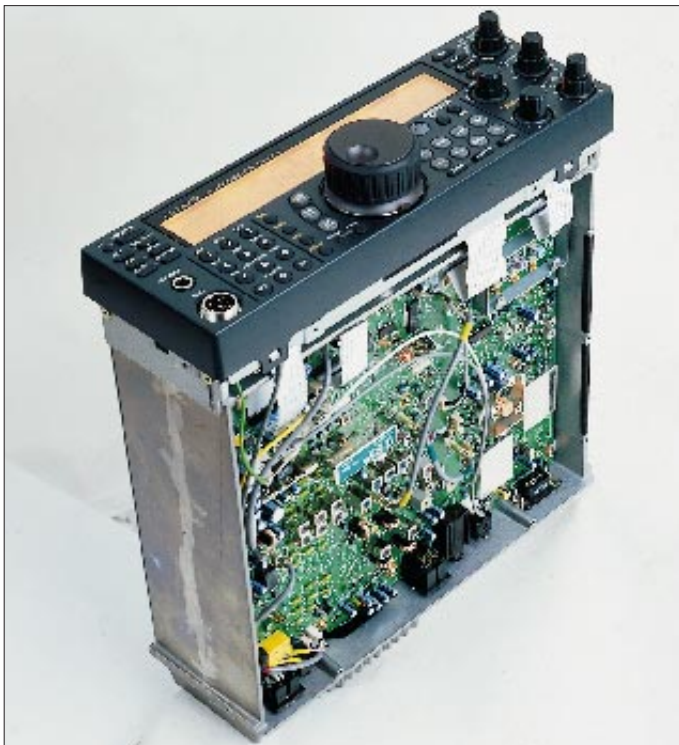
Bild 3: Ansicht von unten in den geöffneten Transceiver. Man beachte das Aluminium-Druckgußchassis, das in Verbindung mit dem Lüfter dafür sorgt, daß die bei 100 W Dauer-Ausgangsleistung entstehende Verlustwärme abgeführt wird.
